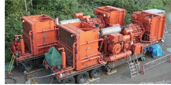
MI製大型高圧コンプレッサーによるサービスで1台当たりの風量が最大で約30m<sup>3</sup>/分と大容量であることが特徴です。さらに2台並列運転させることにより従来の8-1/2"坑掘削のみならず、12-1/4"坑掘削まで対応可能(坑内状況にもよります)となっており、大分地区では主に蒸気井掘削向けとして活躍しています。
