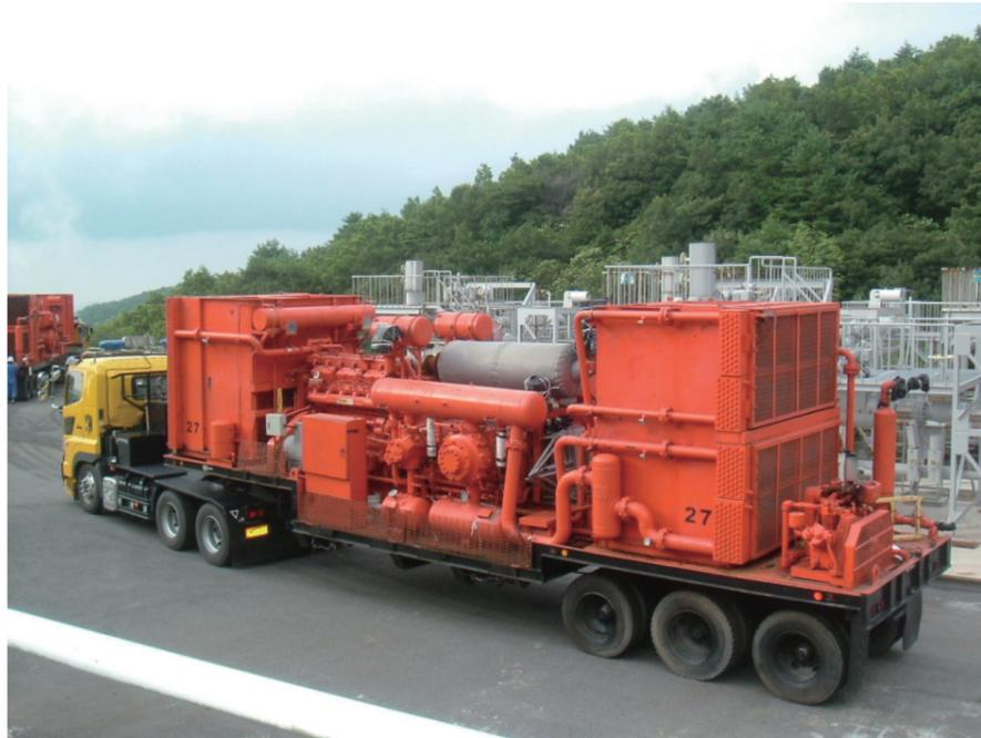
大型・高圧コンプレッサー (主に蒸気井掘削向け)
