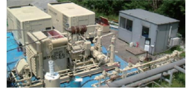
M-I製大型高圧コンプレッサーと比較してコンパクト仕様であることが特徴として挙げられます。大分地区の還元井基地は特に狭小であるため、本システムは重宝し、サイドトラックや浚渫工事に数多く投入されています。標準セットはINGERSOLL-RAND製コンプレッサー2台とDRESSER-RAND製ブースターコンプレッサー1台の計3台で風量は最大約40m<sup>3</sup>/分です。
